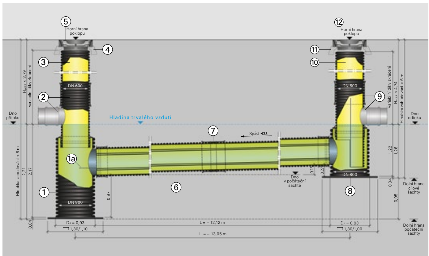
Podélný řez SediPipe L plus 600/12
