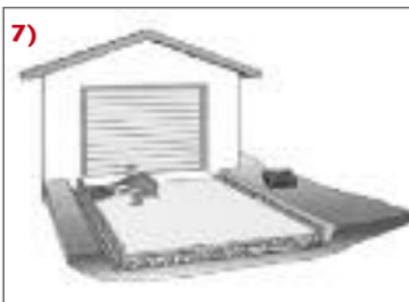
Proved'te montáž zatravňovacích panelů. Dbejte na to, aby nápis „areal“ na panelech byl stále stejným směrem (např. nahoře vpravo). Panely držte mírně šikmo a zaklapávejte do sebe. Výhodné je pokládání ve svazku a ne na křížovou spáru a pokud možno napříč ke směru jízdy.
