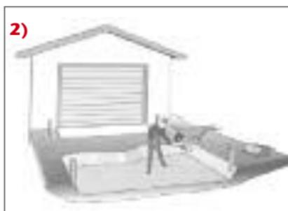
Odeberte zeminu do odpovídající hloubky. Hloubka závisí na požadované únosnosti a na propustnosti podloží. Například před garáž s osobním automobilem 20 - 30 cm při standardním podloží, ale v případě jílovitého podloží až 40 cm.
