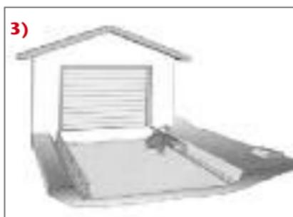
Upravte okraje plochy např. betonovými deskami, obrubníky nebo kameny.
